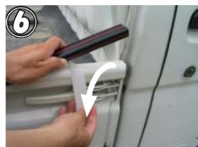
プロテクターの端を浮かせて剥離紙を少し出し、また元に戻します。
